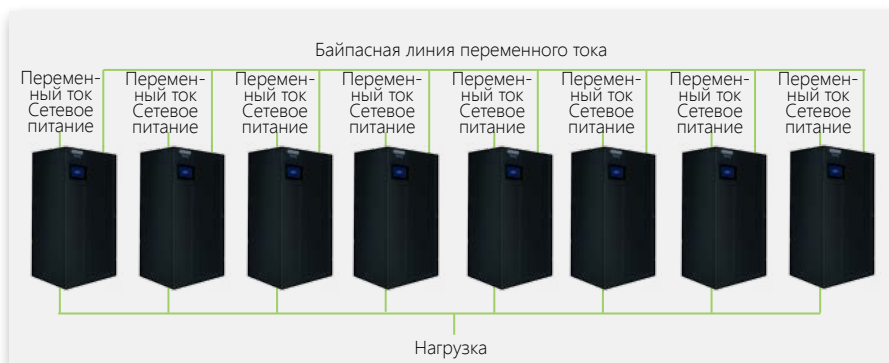
Распределенная параллельная конфигурация Liebert 80-eXL из 8-ми параллельных ИБП.
